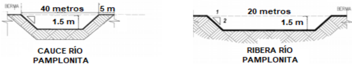
Figura 2 Esquema general de la Geometría y dimensiones de dársenas y descubiertas
