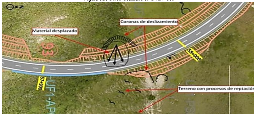
Figura sitio crítico localizado en el K57+950
